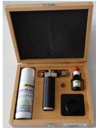
NANOFLAME NF 02 est basé sur le principe de dépôt d'une couche de silane par un traitement de flammage à la surface de matériau à assembler.
